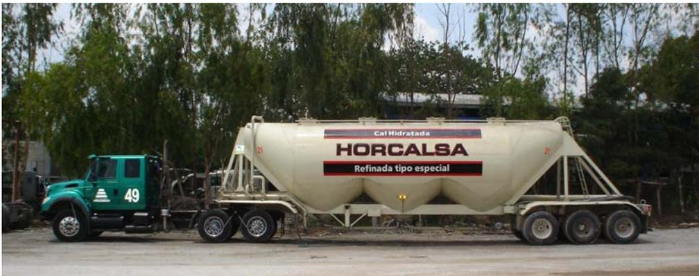
**Figura 5: Ejemplo de pipa típicamente usada para entrega de cal seca.**
